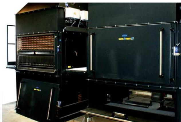
Photo : Filtre ULTRAVENT® électrostatique avec filtre dévésiculaire et un échangeur de chaleur (de bas en haut). Le système de nettoyage automatique de filtre est placé entre le filtre électrostatique et le module échangeur de chaleur.
